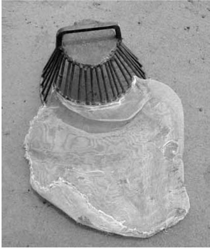
**Figura 10.** Nasa fabricada en hierro para la captura de rayas
